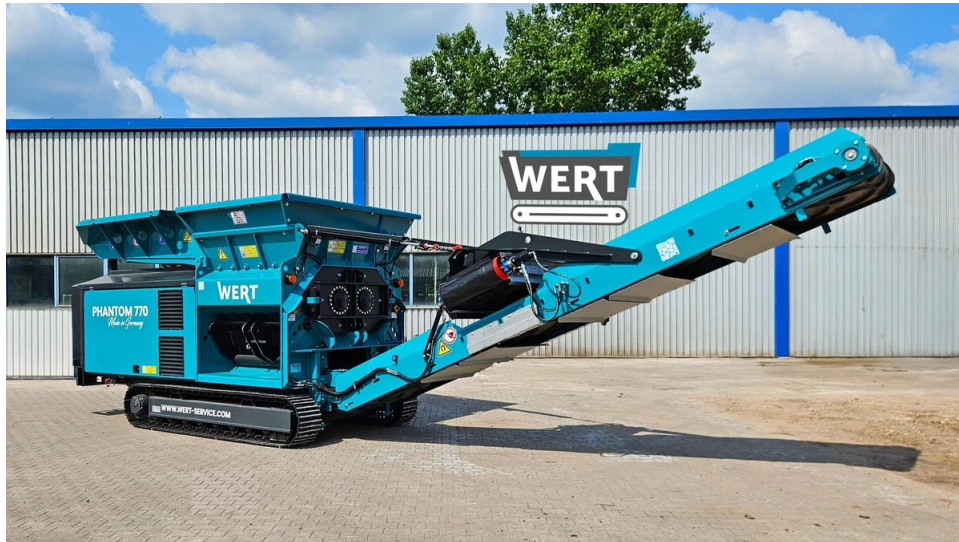
Der Multimaterial-Zerkleinerer Wert Phantom ist in einem Standardcontainer transportierbar. © Wert GmbH
